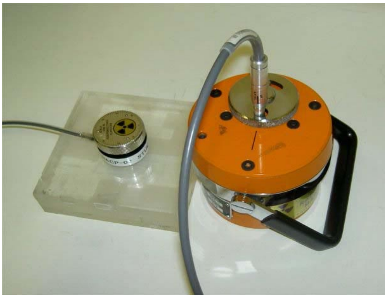
Kuva 5. Kammiot tarkistuslähteissä. Vasemmalla tasovevykammio, jonka päällä on tarkistuslähte pidikkeessään. Kammion alla tulee käyttää esim. pleksilevyä (PMMA) tasaisen takaisinsironnan aikaansaamiseksi. Oikealla on sylinterikammio tarkistuslähteessä, jossa kammion viivamerkki tulee asettaa lähteen viivamerkin suuntaiseksi.
