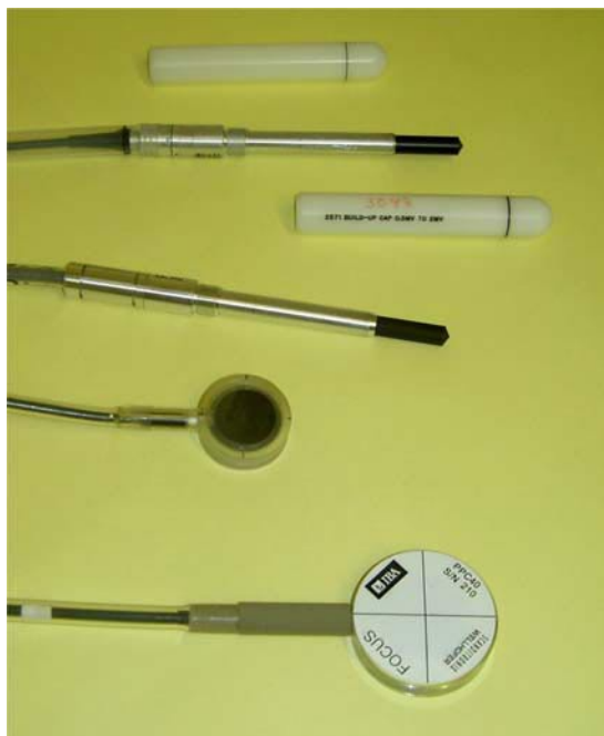
Kuva 2. Erilaisia ionisaatiokammioita. Ylhäällä kaksi Farmer-tyyppistä sylinterikammioita, alhaalla elektronisäteilyn mittauksissa käytettävät NACP-02- ja Roos-tyyppin tasolevykammiot. Sylinterikammioiden vieressä näkyvät kasvupäällykset ovat ilmassa tehtäviä mittauksia varten ja toimivat myös grafiittisen kammion mekaanisena suojana.
