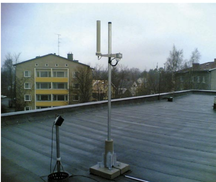
Kuva 2.2. Ulkoisen säteilyn valvonta-aseman mitausanturi (1652 Forssa). Bild 2.2. Detektor vid en mätstation för extern strålning (1652 Forssa). Fig. 2.2. Detector of an automatic dose rate monitoring station (1652 Forssa).
