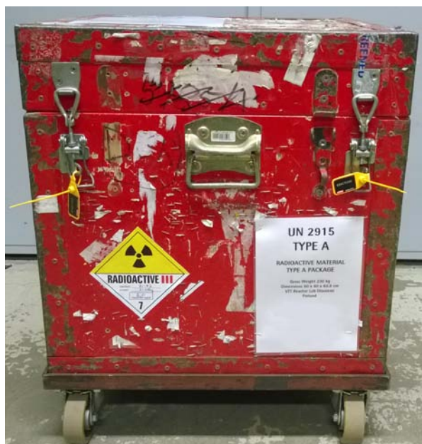
Esimerkki A-tyyppin kollista, johon on kiinnitetty sinetit. Kuva: Ville Pitkänen.
