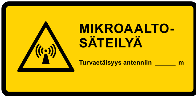
Kuva 1. Esimerkki tukiasema-antennin kiinnitettävästä varoitusmerkistä
