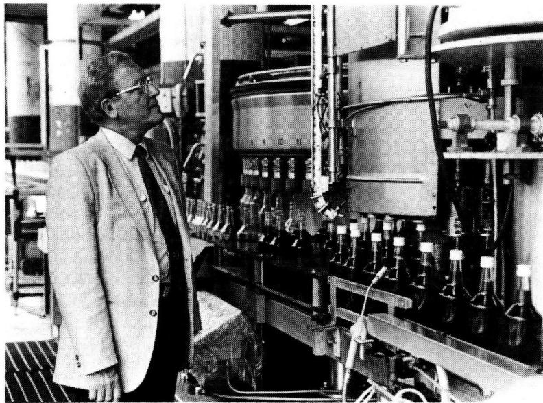
— Pullotuskone on meillä tärkeä työväline. Yhden sarjan kapasiteetti on n. 20 000 pulloa tunnissa, ja työntekijöitä sarjalla on 15—16. Tekninen kehitys on kuitenkin nopeaa, ja maailmalla on sarjoja, jotka pullottavat n. 50 000 pulloa tunnissa, ja työntekijöitä on neljä.
