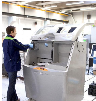
Kuva 7. Sideaineen suihkutukseen perustuva teollinen 3D-tulostin.
