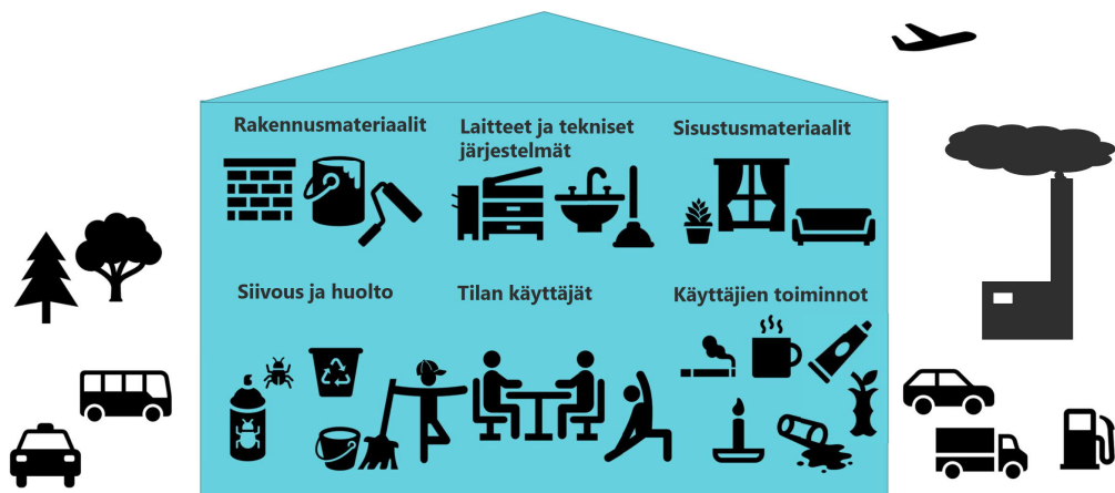
Kuva 1. Sisäympäristöissä esiintyvillä haihtuvilla orgaanisilla yhdisteillä on sekä rakennuksen sisäisiä että ulkoisia lähteitä.
