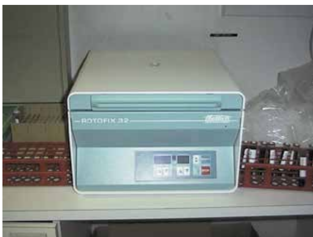
Kuva 1. Hettich Rotofix 32 sentrifugiin menevien putkien teline on kuvassa fugin oikealla ja ulostulevien teline odottaa vasemmalla puolella.
