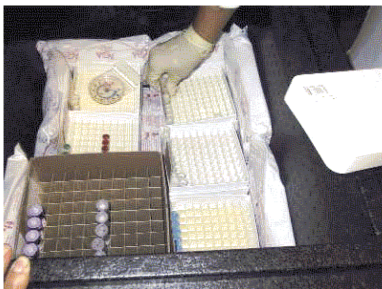
Kuva 9. Näytteiden lajittelu styrox-arkkuun. Arkun pohja ja reunat vuorattu hiilihappojäällä.
