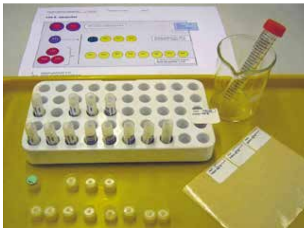
Kuva 5 . Jakoputkien korkit aukaistaan valmiiksi näytteenkäsittelypöydällä. Takana on putkien pipetointikaavio. Etuoikealla näkyy tarra-arkki, jossa on jäljellä vain varatarrat
