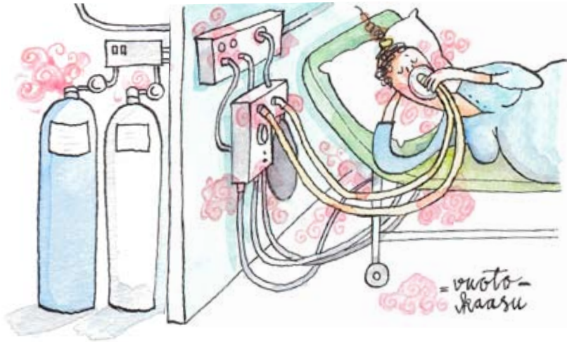
Kuva 5. Ilokaasun vuotokohtia ovat mm. annostelulaitteiden vahingoittuneet sekoituspusstit ja epätiivit liitokset. Myös kaasulinjaverkostossa voi olla vuotoja esimerkiksi linjojen haarakohdissa ja venttiileissä. Annostelulaitteiden huoltovastuu tulee olla tarkoin määritelty sairaalassa.
