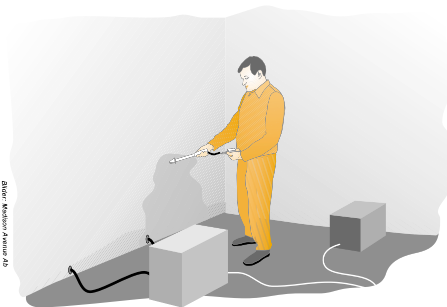
Mätning av mikrovågsstrålning i närheten av objektet under torkningen.
