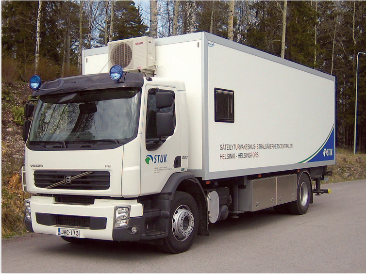
Kuva 10.1a. Kokokehomittauksissa käytettävä liikkuva laboratorio.
