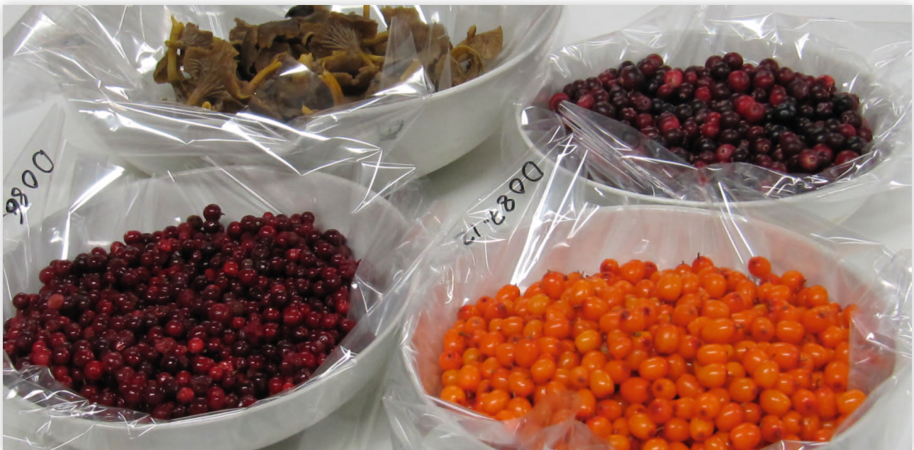
Kuva 9.2. Näytteet kuivataan ja homogenisoidaan. Kuivatuista näytteistä määritetään ^{137}\text{Cs} -pitoisuus. Bild 9.2 Proven torkas och homogeniseras. Ur de torkade proven bestäms halten av ^{137}\text{Cs} . Fig. 9.2 The samples are dried and homogenised. The activity concentration of ^{137}\text{Cs} is determined from the dried samples.
