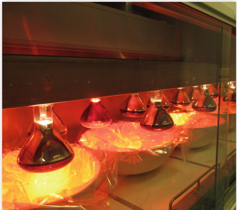
Kuva 7.2. Vesinäytteiden konsentrointi haihduttamalla.
