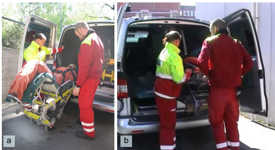
Kuva 12. Parien lastaus ambulanssiin. a) Pensin lastaus on koneellistettu Ergomy -tuotteella. b) Ferno ja Stryker pitää liuttaa lastausalustaa pitkin käsin kannatteleamalla.
