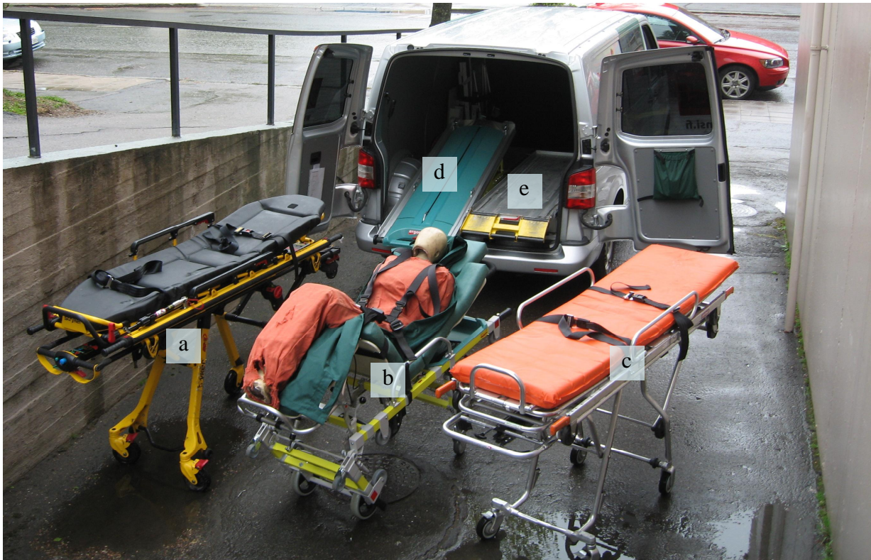
Kuva 1. Tutkimuksessa mukana olleet parit a) Stryker b) Pensi c) Ferno. Taustalla pakettiauto, jonka tavaratilassa on asennettuna parien vaatimat lastausalustat. d) Ergomy lastausavustin Pensi parille. e) Alusta Ferno ja Stryker paareille.
