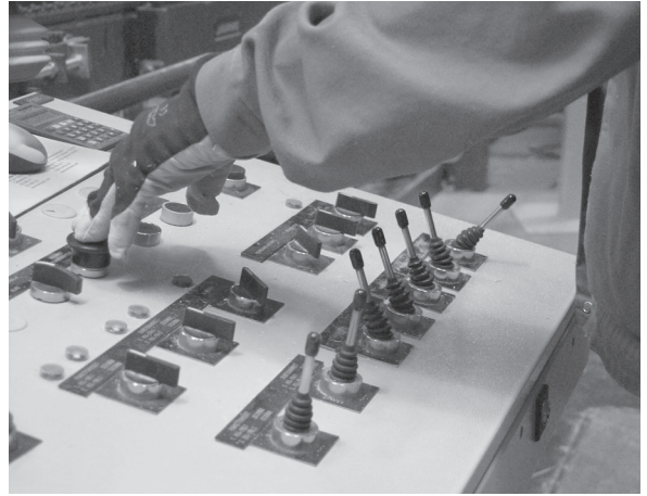
Kuva 17.20. Ohjaimia ei saisi sijoittaa siten, että toisten ohjaimien käyttö edellyttää kurottelua niiden yli, jolloin vahinkokäyttö on mahdollista.
