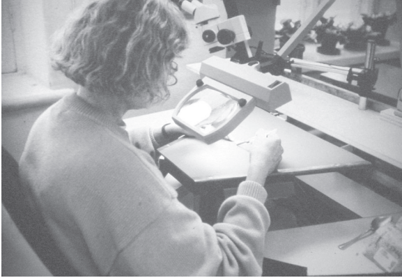
Kuva 11.6. Teline pienten esineiden käsittelyä varten suurta näkö tarkkuutta vaativassa työssä.
