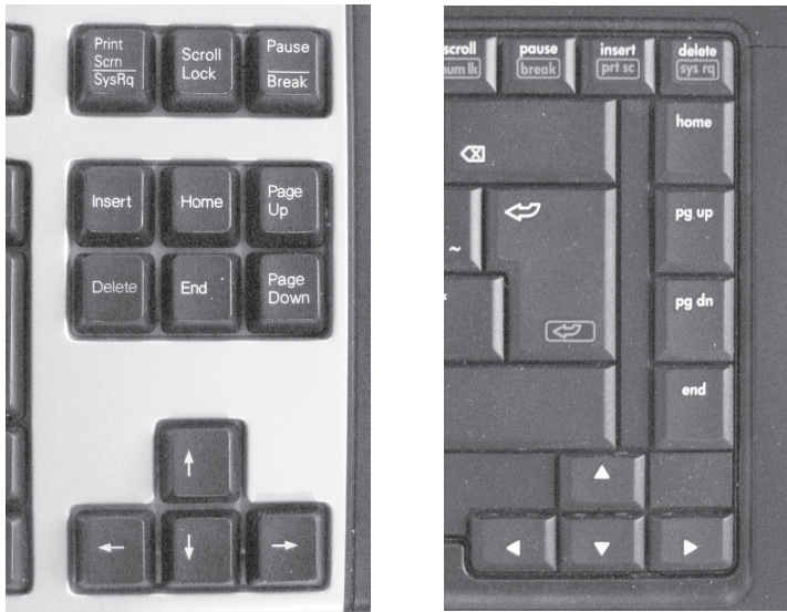
Kuva 17.25. Kannettavan tietokoneen näppäimistössä ja erillisessä näppäimistössä on kiusallisia eroja, jotka saattavat aiheuttaa sen, että irrallista, vapaasti sijoitettavaa näppäimistöä ei haluta käyttää. Hyvää kummassakin ratkaisussa on kohdistimen ohjausnäppäinten sijoittelu – kohdistin siirtyy sinnepäin, missä näppäin on. Neliöön tai riviin asetetuilla nuolinäppäimillä tätä suuntavastavuutta ei ole.
