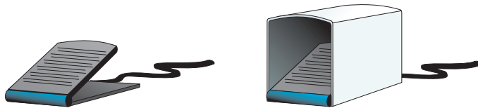
Kuva 17.19. Suojaamatonta jalkaohjainta ei voi käyttää, jos käyttötilanteeseen liittyy jokin vaaratekijä. Ohjaimen ja suojan mitoituksessa on otettava huo-mioon jalan koko ja työasennon tasapainoisuus.
