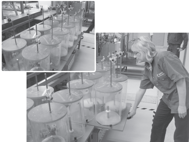
Kuva 9.6. Viirankudontakoneessa olevien lankamakasiinien täyttö on helppoa, kun ne voidaan vetää esille ja täyttää kurkottelematta. Samanlainen vetotaso-ratkaisu on käytössä joissakin varastohyllyissä.
