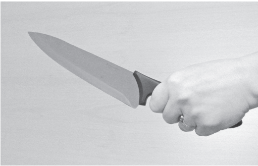
Kuva 14.8. Käytännössä eri voiman välittämisen tapoja yhdistellään muotoilemalla kädensijaan tukipintaa haluttuun voimantuoton suuntaan. Keittiöveitsessä on usein kaareutuva tukipinta kahvan terän puoleisessa päässä, jotta käden lipsahtaminen terää vasten estyy.
