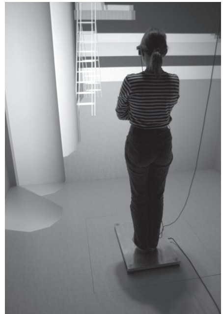
Kuva 23.29. Virtuaalitodellisuudessa ihminen näkee ympäristönsä oikeasti kolmiulotteisena, mutta yhdestä pisteestä kuvattu valokuva tilanteesta näyttää oudolta. Kuvassa on virtuaalitala, jossa ympäristö heijastetaan seinille. Henkilö seisoo tasapainoa mittaavan voimalevyn päällä.
