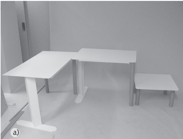
Kuva 23.27. Laboratoriotyöpisteen kehittäjä: a) kevytrakenteinen ja nopeatekoinen pahvimalli työpisteen hahmottamiseen ja tilavaatimusten arviointiin b) mitoituksen testaamiseen tarkoitettu työpaikkamalli, mock-up; työtasojen korkeudet ovat sähkömoottorisäätöiset mitoituksen määrittämiseksi säätökokeilujen avulla c) säätökokeilujen perusteella tehty kevyt prototyyppi työpisteessä tapahtuvaa työn sujuvuuden arviointia varten.
