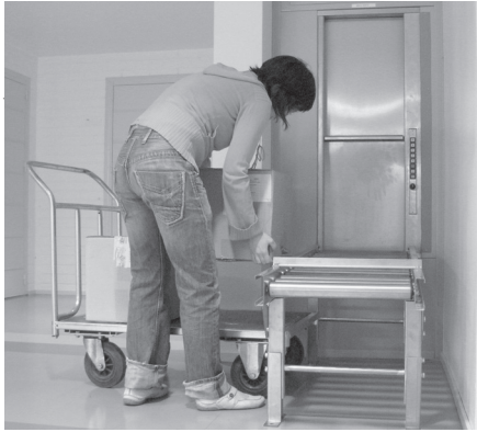
Kuva 13.2. Tarpeetonta nostamista voi syntyä silloin, kun vaihdetaan kuljetusvälinettä. Tasoerojen pitää tällöin olla mahdollisimman pieniä ja nostokohdan hyvällä, noin 75 cm korkeudella. Ihmisten kokoerot vaikuttavat luonnollisesti hiukan siihen, mikä on sopiva nostokorkeus.
