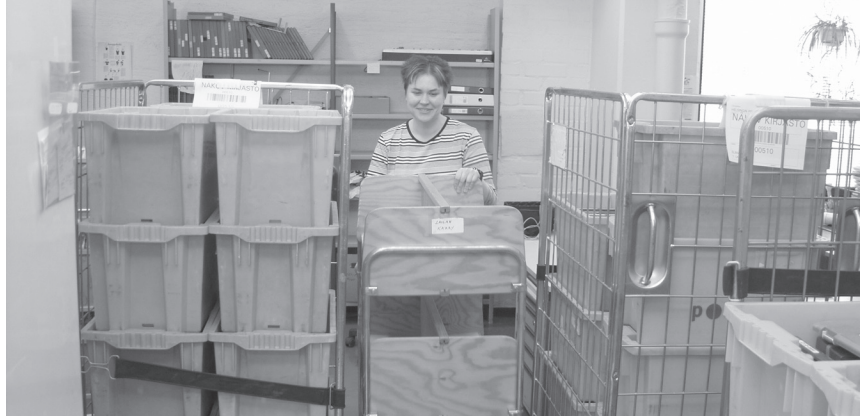
Kuva 20.4. Olevien kalusteiden ja välineiden avulla voidaan hyvin yksinkertaisesti kokeilemalla määrittää työpisteiden välissä tarvittavan kulkutilan leveys
