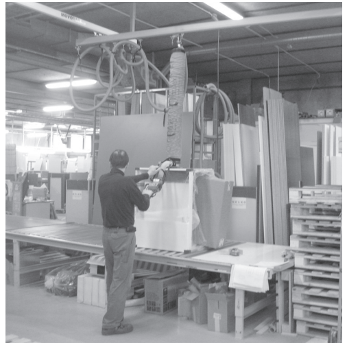
Kuva 22.1. Pakkauslinjan rakentamisessa tavoitteena oli raskaiden ja hankalien nostojen poistaminen. Se toteutettiin vapaasti liikuteltavan tasapainonostimen avulla.
