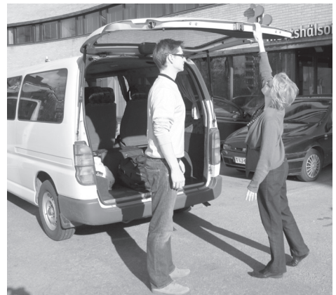
Kuva 3.4. Joissakin tilanteissa voi sama mitta olla kriittinen sekä suurelle että pienelle käyttäjälle: suuren käyttäjän on mahdollista takaluukun alle ja pienen on ulottuttava siihen.
