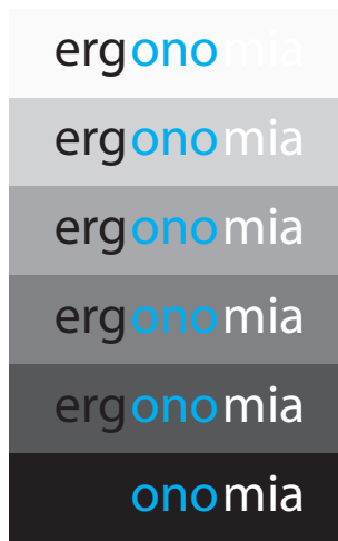
Kuva 17.7. Kontrastisuhteiden vaihtumisen vaikutus näkemiseen. Vihreiden merkkien ja harmaan pohjan värikontrasti ei ole kovin hyvä, mutta hyväkään värikontrasti ei yksin riitä, vaan erottaminen edellyttää suurta luminanssikontrastia.
