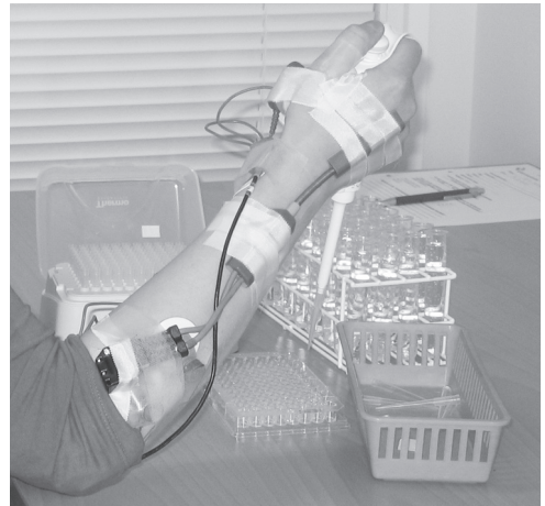
Kuva 23.15. Käteen teipatut nivelkulmamittarit ja EMG-anturit antavat kokonaiskuvan käden liikkeistä ja asennoista sekä lihasten kuormittumisesta liikkeiden eri vaiheissa.
