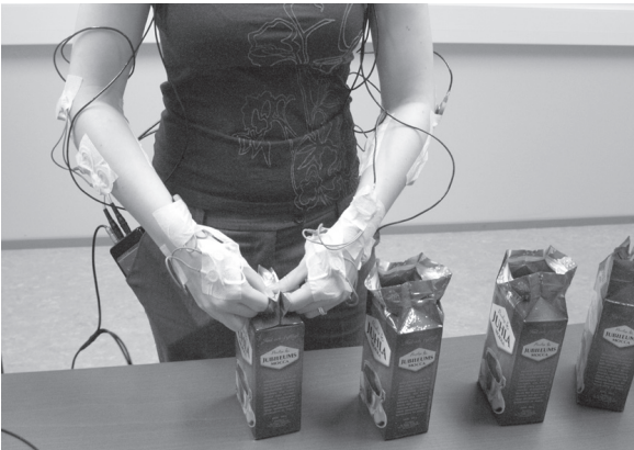
Kuva 23.14. Lihaksen sähköistä aktiivisuutta mittaamalla (EMG, elektromyografia) voidaan mitata ja arvioida eri lihasten suhteellista kuormittumista työtehtävän aikana. Tieto voidaan yhdistää työvaiheisiin esimerkiksi samanaikaisesti kuvatun videon avulla.
