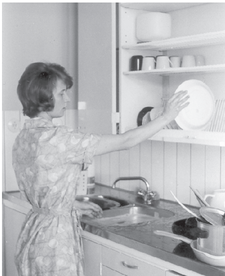
Kuva 10.9. Suomalainen innovaatio astiankuivauskaappi tiskipöydän yläpuolella on käytännöllinen, mutta vaatii yksittäisten astioiden toistuvaa nostelua korkeille hyllyille (Työtehoseuran arkisto).
