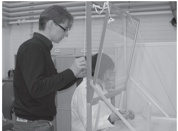
Kuva 23.31. Säätökoe lamiinaarikaapin parhaan mahdollisen etulasin kallistuskulman määrittämiseksi.
