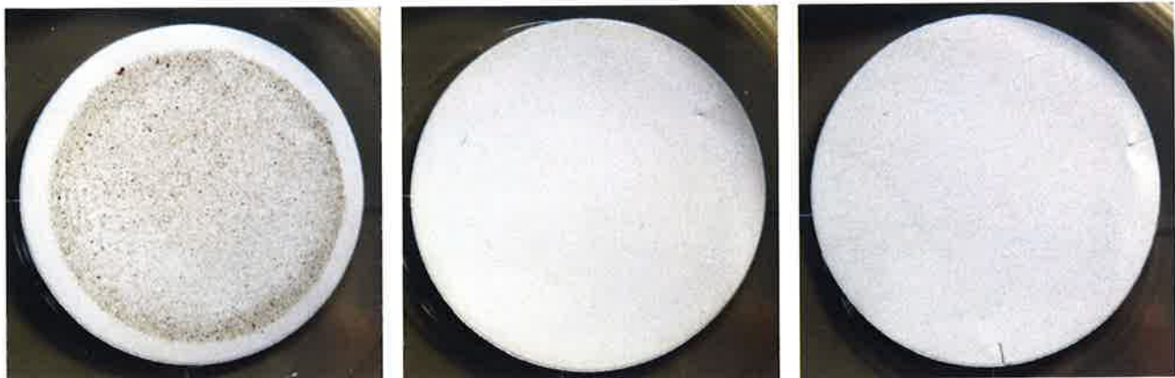
Esimerkkikuva Helsingissä kerättyjen pienten tilavuuden näytteiden suodattimista: vasemmalla raakavesinäyte, keskellä verkostoon lähtevä vesinäyte ja oikealla verkostovesinäyte.
