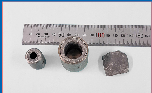
Högaktiv ^{241}\text{Am} sluten strålkälla med skydd och skyddslock
