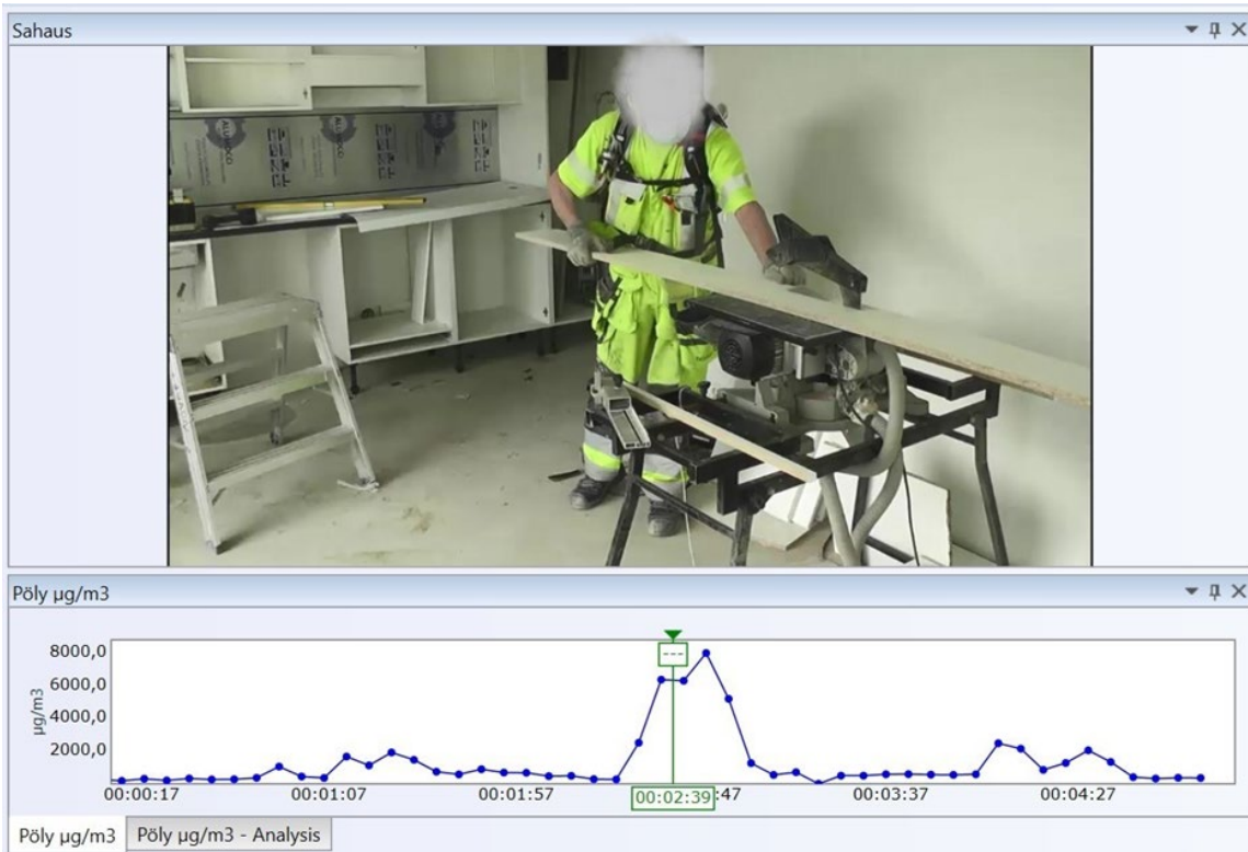
Kuva 26. Esimerkkikuva työntekijästä sahaustyössä. Pölymittarilla työssä työntekijän hengitysvyöhykkeeltä mitattu pölypitoisuuden kuvaaja yhdistettynä videokuvaan. Videokuvan pysäytyshetkellä sahaus käynnissä ja pölypitoisuus kohonnut hetkellisesti 6–8 mg/m 3 tasolle.
