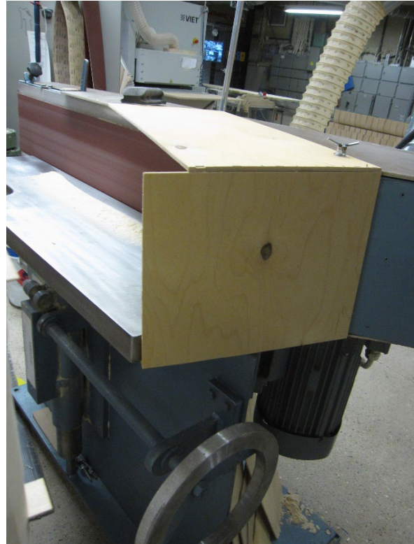
Kuva 24. Kapeanauhahiomakoneeseen itse rakennettu lisäohjain.
