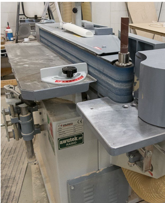
Kuva 25. Työpaikkakäyntien parhaiten koteloitu kapeanauhahiomakone edestä ja takaa.
