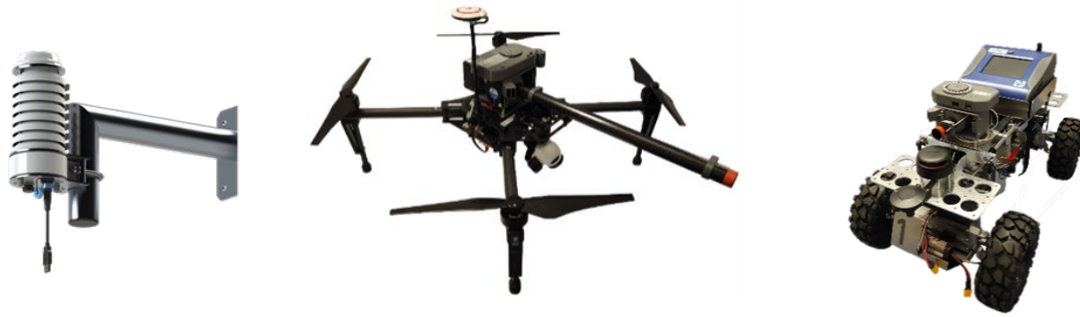
Kuva 2. Mittauksissa käytetyt kiinteä tiedonkeruuyksikkö sekä liikkuvat mittausyksiköt: drooni ja maarobotti.
