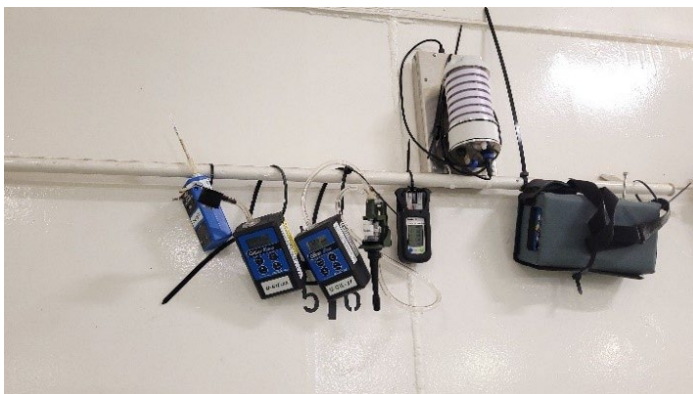
Kuva 1a. RASEM sensori ja vertailumittauslaitteisto.
