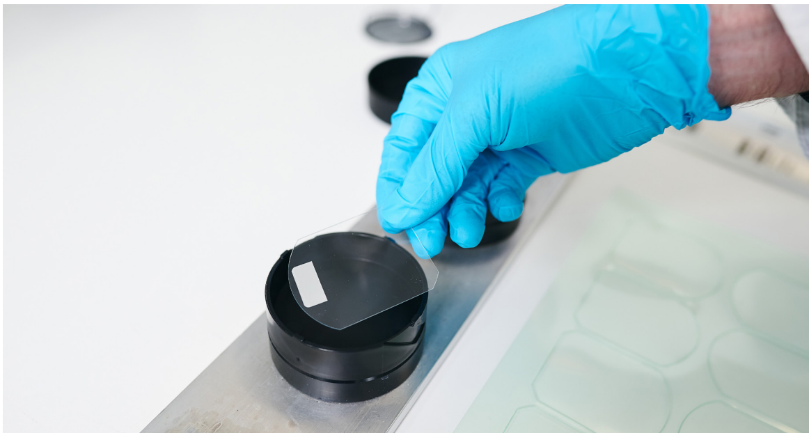
KUVA 4. Radonmittauspurkki on pieni muovirasia, jonka sisällä on radonille herkkä filmi.
