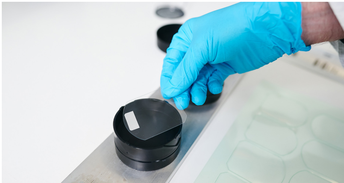
BILD 4. Radonmätburken är en liten plastlåda som innehåller en radonkänslig film.
