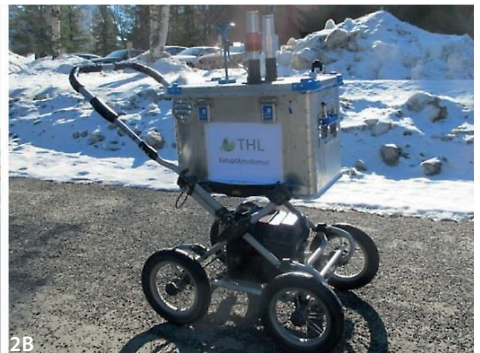
Kuvat 2A ja 2B. Henkilökohtaisen altistumisen mittaus Kuopion keskusta-alueen katupölytutkimuksessa. A. Pölyävä näkymä reitiltä mittauskävelyn aikana. B. Altistumisen mittauksessa käytetty työntökärry, johon oli sijoitettuna taulukossa 1 esiteltävät mittalaitteet. Kuvat: Taina Siponen.
